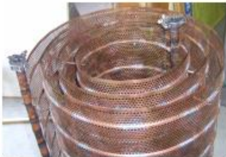
Abb. 8: Anfertigung des Sorptionswärmetauschers bei der Firma „Behältertechnik Pink GesmbH“, Rohre werden ganzseitig in einem Lötöfen gelötet (links) und nachher eng zusammengerollt und auf Dichtheit getestet (rechts).
