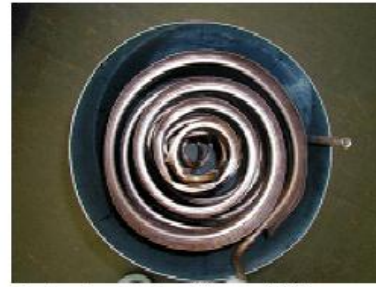
Fig. 7: Foto des Spiralfinen Wärmetauschers von oben. Die Oberfläche ist noch nicht auf ein hohes \epsilon behandelt. Dieser Wärmetauscher ist im Sorptionsmodul eingebaut.
