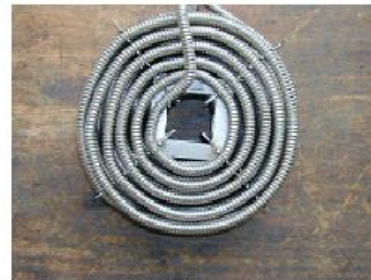
Fig. 9: Foto eines Spiralschlauch Wärmetauschers von oben. Zwei solche Wärmetauscher sind in der Wasservorlage eingebaut.
