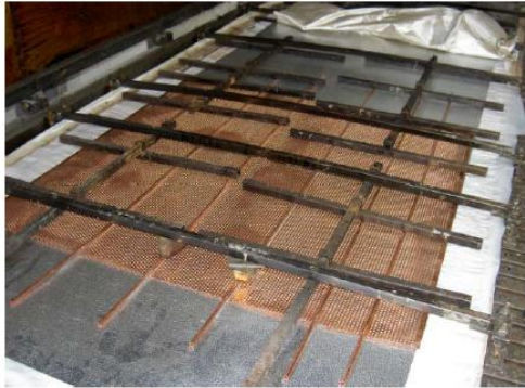
Abb. 8: Anfertigung des Sorptionswärmetauschers bei der Firma „Behältertechnik Pink GesmbH“, Rohre werden ganzseitig in einem Lötöfen gelötet (links) und nachher eng zusammengerollt und auf Dichtheit getestet (rechts).
