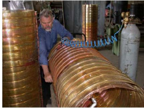
Abb. 8: Anfertigung des Sorptionswärmetauschers bei der Firma „Behältertechnik Pink GesmbH“, Rohre werden ganzseitig in einem Lötöfen gelötet (links) und nachher eng zusammengerollt und auf Dichtheit getestet (rechts).
